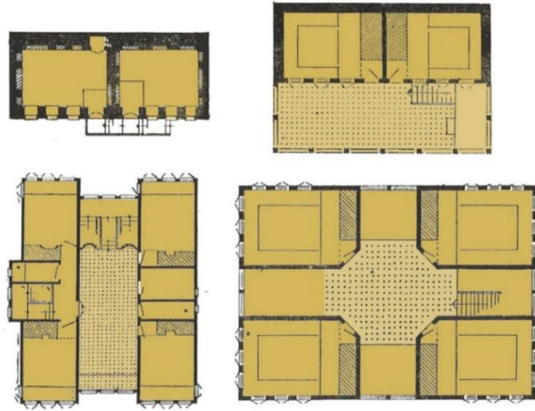
Şekil 6. Osmanlı döneminde izlenen sofasız, dış sofalı, iç ve orta sofalı konut plan şemaları (Eldem, 1954)
